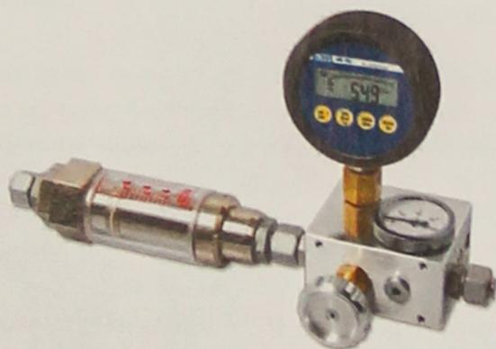
**Hydraulik-Prüfgerät. Druck, Durchfluss, Temperatur.**
