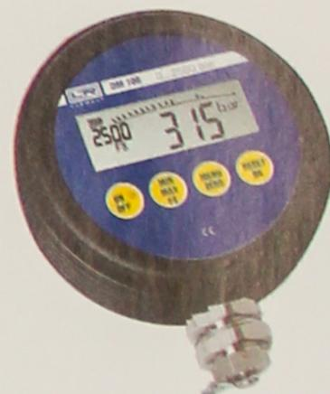
**Digitales Manometer zur Ermittlung und Messung von Drücken.**
